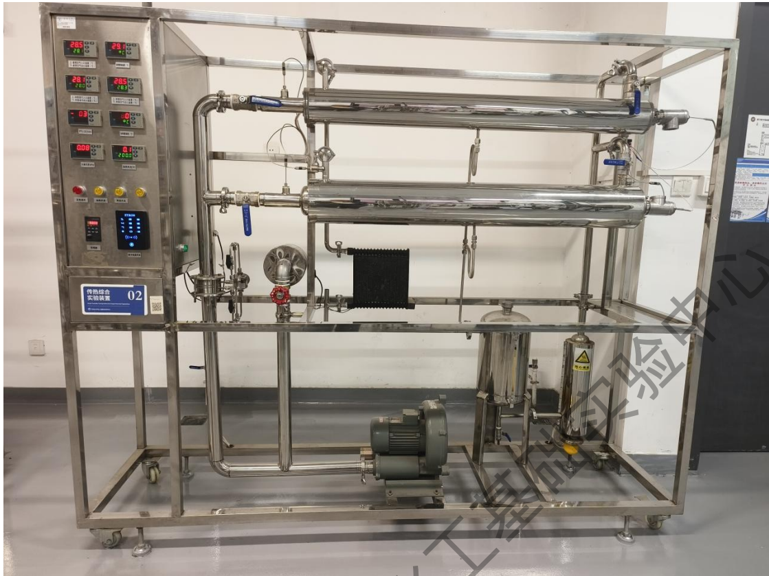
图2 传热实验装置实物照片
